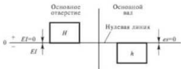
Рис. 5.16. Гранично однобічне розташування полів допусків основного отвори (H) і основного вала (h)
