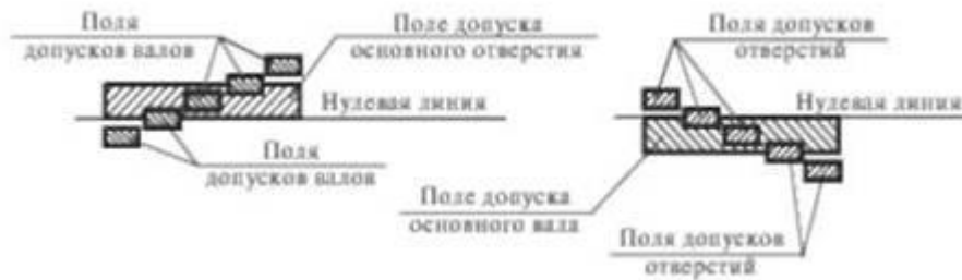
Рис. 5.19. Схема розташування полів допусків отворів і валів в системі отвору і системи вала
