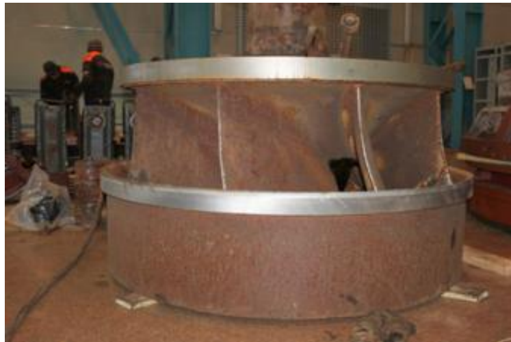
Рис. 2 – Корозійне руйнування поверхні робочого колеса турбіни ГЕС
