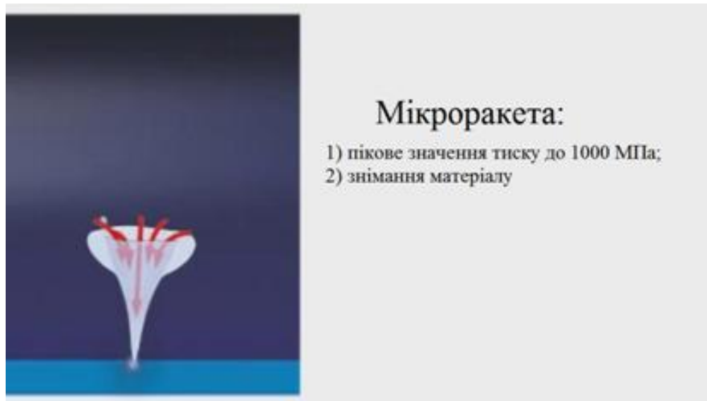
Рис. 6 – Принцип дії кавітації на поверхні обладнання
