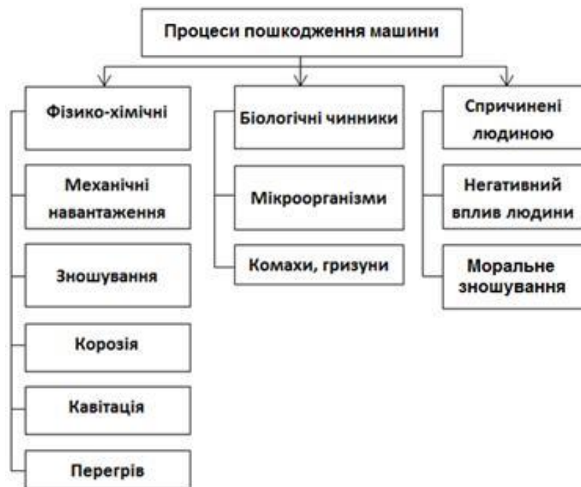
Рис. 1 – Основні процеси пошкодження машин
