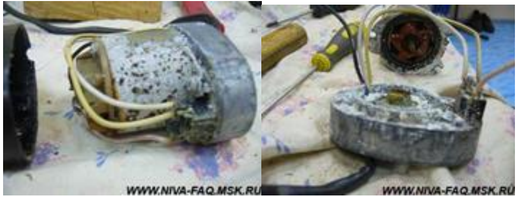
Рис. 10 – Пліснява на моторі-редукторі очисника фар автомобіля
