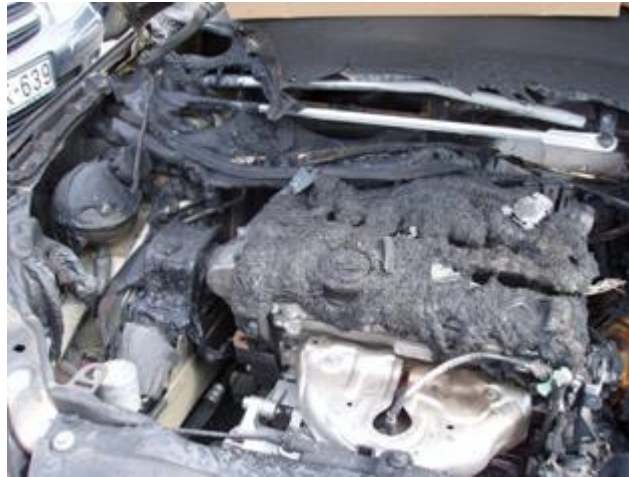
Рис. 8 – Наслідок перегрівання деталей машин (двигун автомобіля Citroen C4, на якому проїхали 220 км на першій передачі)
