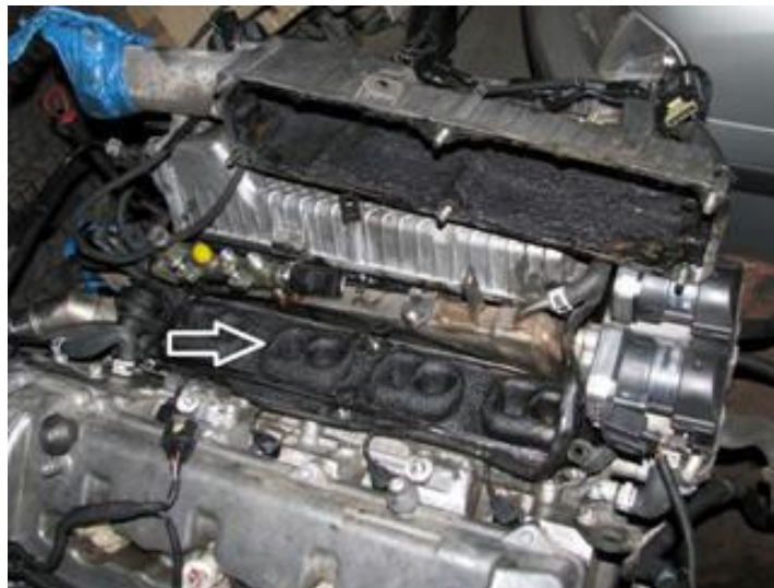
Рис. 9 – Нагар на впускному колекторі (складається із мастила та частинок сажі)
