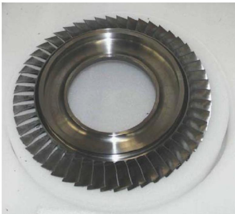
Рис. 3.8 - Моноколесо (Бліск) осьового компресора
