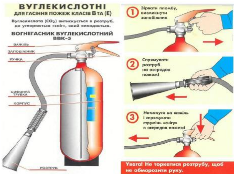
Рисунок 1.4 - Будова та спосіб приведення в дію вуглекислотного вогнегасника
