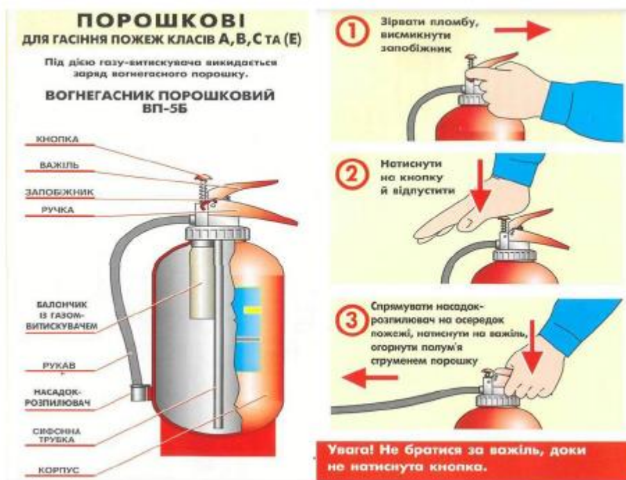
Рисунок 1.3 – Будова та спосіб приведення в дію порошкового вогнегасника
