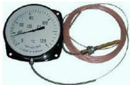
Рисунок 15 – Конденсаційний манометричний термометр
