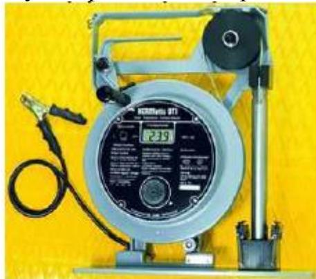
Рис. 8 Переносний електронний рівнемір — HERMetic
