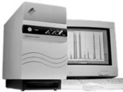
Рис. 6. Енергодисперсійний аналізатор "Спектроскан Макс"
