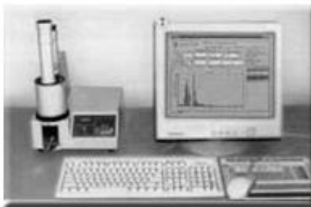
Рис. 7. Рентгеноспектральний аналізатор "ПРИЗМА"
