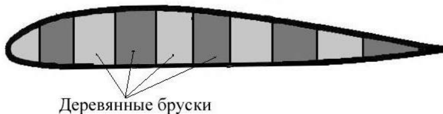
Рис. 3. Перетин дерев'яної лопати.
