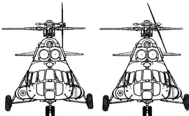
Малюнок 3. Горизонтальна й похила вісь кермового гвинта на вертолітоті.
