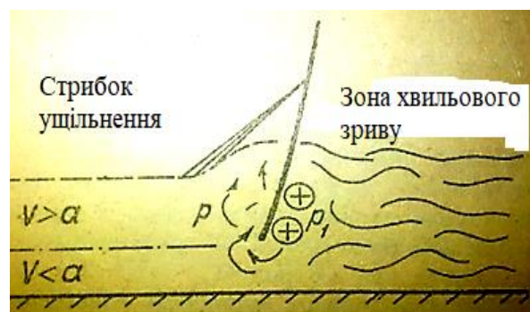
Рис 3.1.27 Схема виникнення хвильового відриву в примежовому шарі
