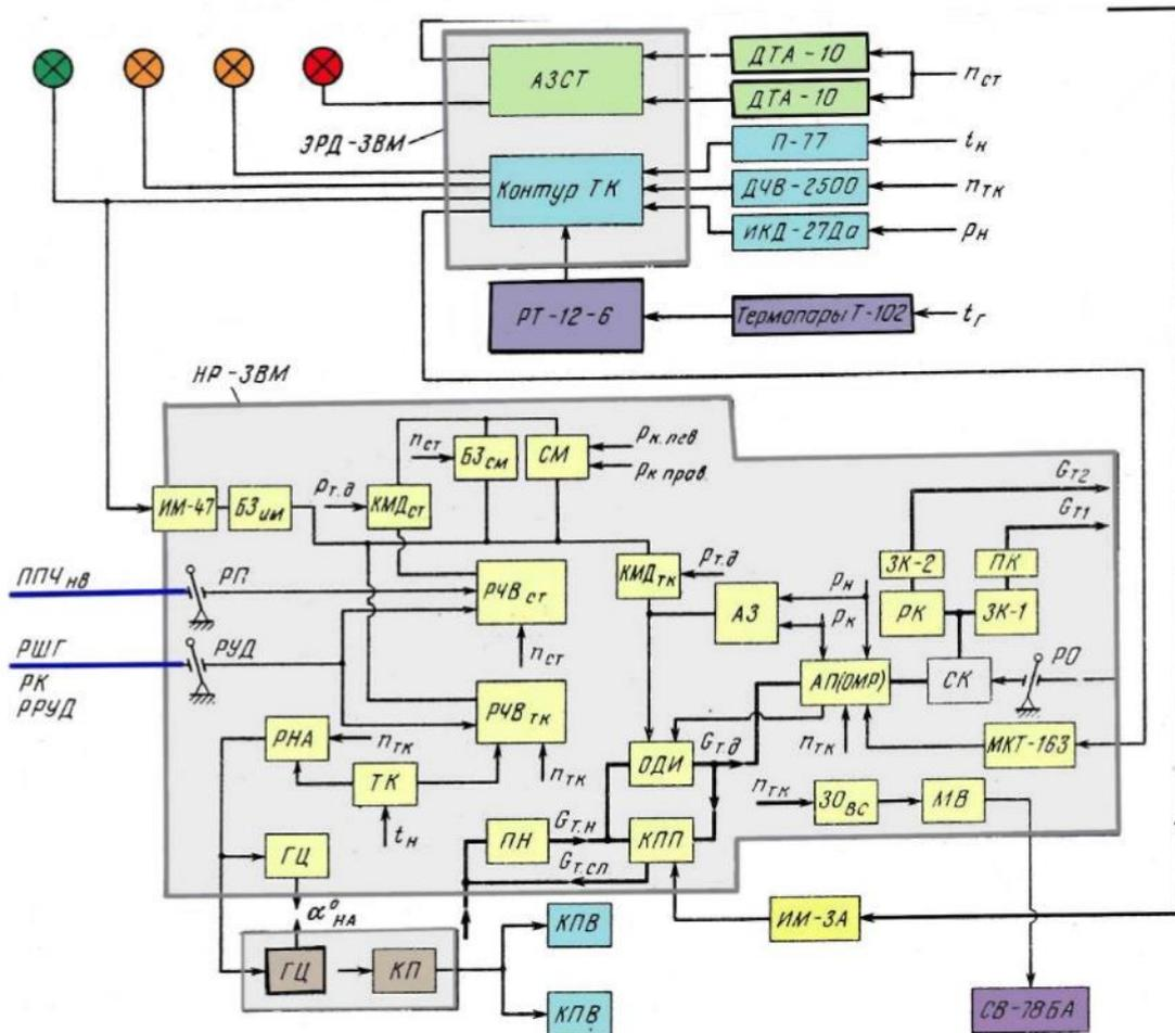
Структурно - функціональна схема регулювання двигуна.
