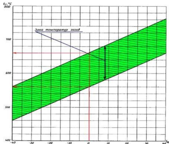
*Залежність максимальної  $t_2$  від  $t_1$  на вході в термопатрон НР-3ВМ*
