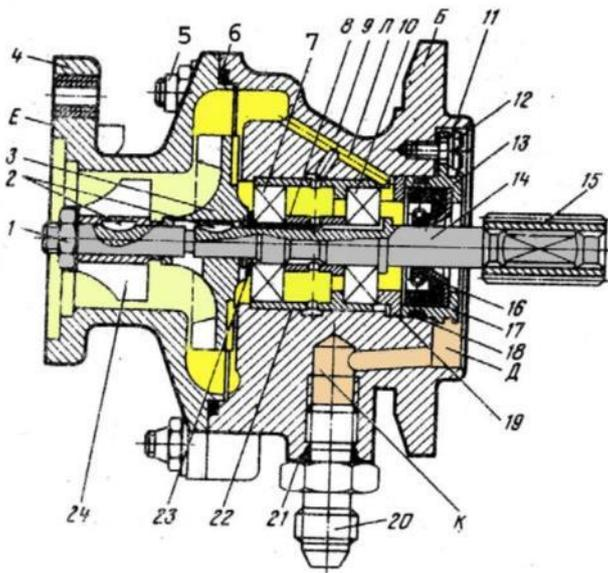
1,5-гайки, 2-шпонки, 3 робоча крильчатка, 4 кришка, 6,18,21-кільця ущільнювачів, 7,10-кулькові підшипники, 8-втулка розпору, 9-корпус, 11-шайба, 12- гвинт, 13-корпус ущільнення, 14- вал, 15-шліцьова втулка, 16- конус, 17- манжета 19- втулка наполеглива, 20- дренажний штуцер, 22-стакан підшипників, 23-регулювальні шайби, 24-додаткова осьова крильчатка, Е, Б - фланці, Д
