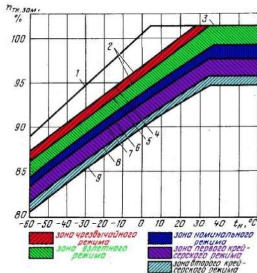
Перед перевіркою необхідно відключити регулятор температури РТ-12-6, встановити важіль перенастроювання в положення  $\alpha\text{ПЕР} = 66 \pm 2^\circ$ , визначити необхідну величину НТК для злітної режиму за графіком «АЕРД» з урахуванням висотної поправки.
