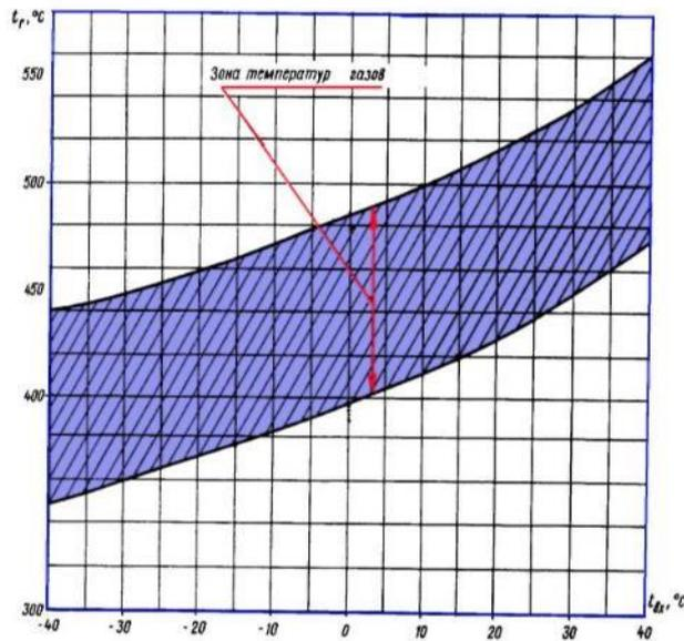
Залежність тг при птк пр = 40% від тн на вході в термопатрон НР-3 при налагодженому запуску
