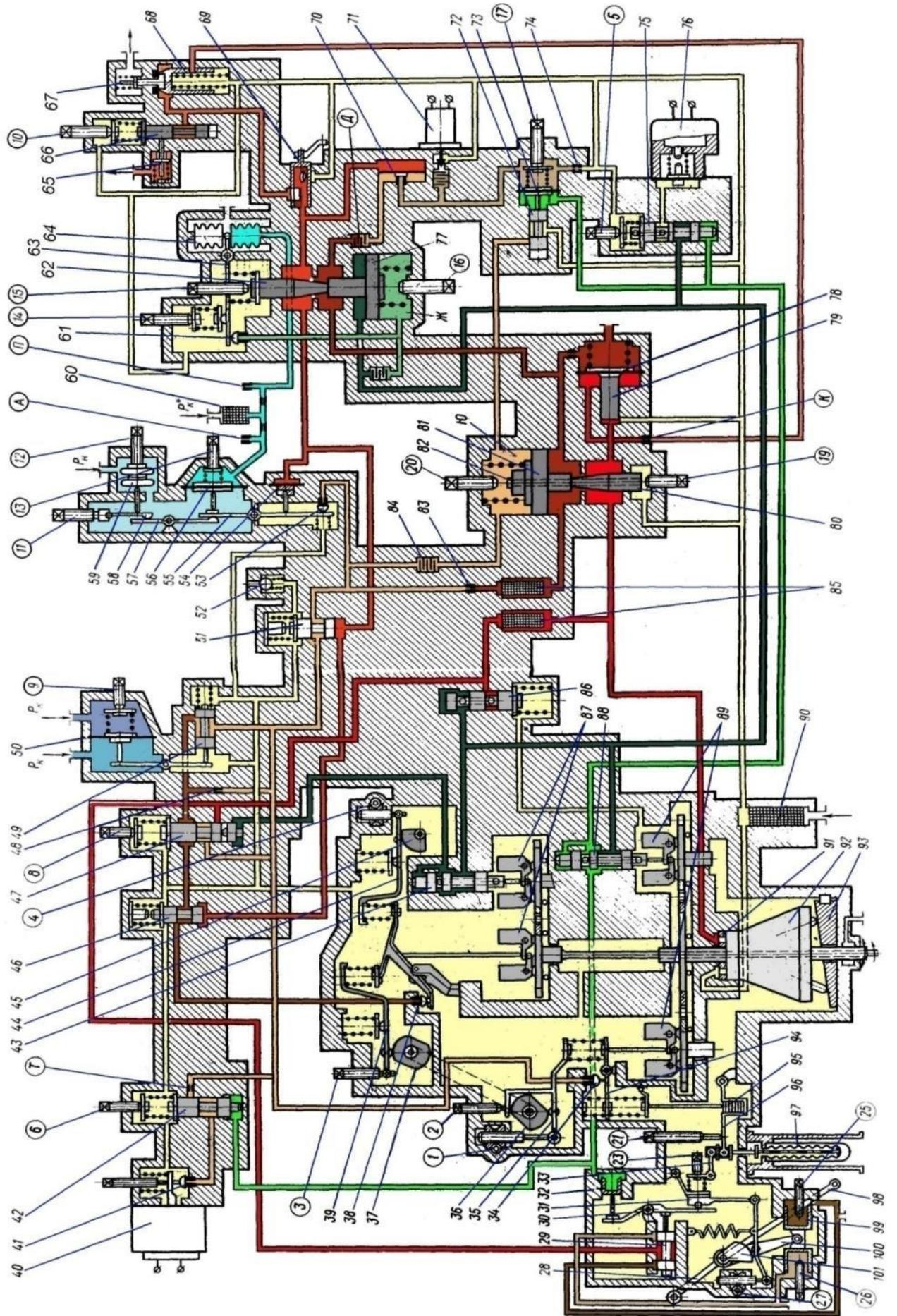
Для запобігання витоку палива з порожнини насоса в коробку приводів в його конструкцію включено торцеве ущільнення з плаваючою і опорної втулками і кришкою. Просочилося паливо через дренажний штуцер відводиться в вихлопної патрубков.
