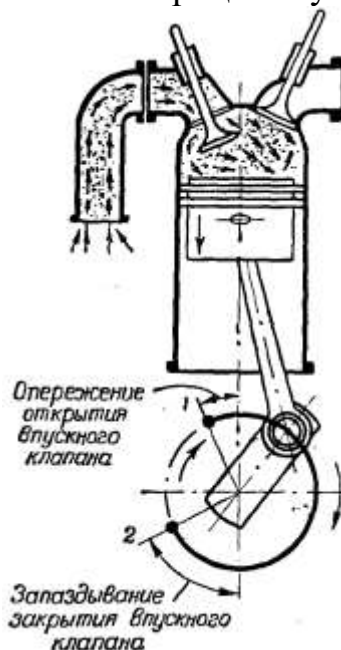
Рисунок 8. Процес впуску: 1 – момент відкриття впускного клапану; 2 – момент закриття впускного клапану
