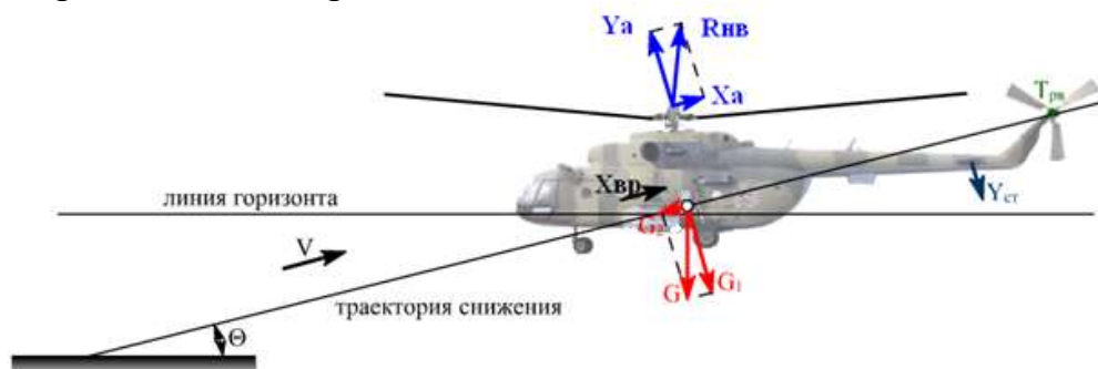
Рис. Схема сил, що діють на вертоліт при зниженні по похилій траєкторії
