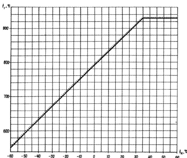
Рис. 9. Залежність максимально допустимої температури газів від температури зовнішнього повітря при перевірці часткової приемистості по термопар Т-102
