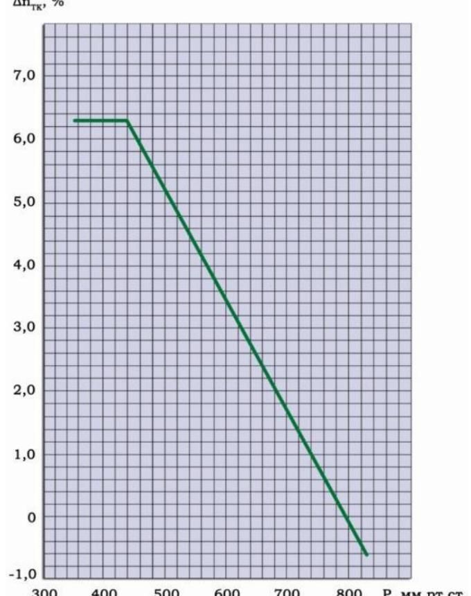
Графік А - залежність заміряній частоти обертання ротора турбокомпресора від температури повітря на вході в термопатрон на злітній режимі;
