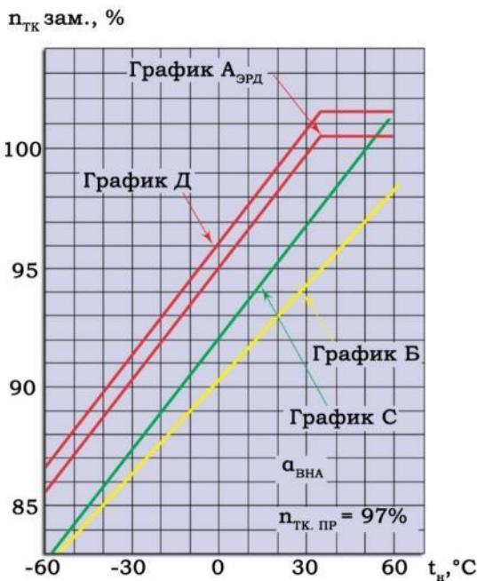
Рис. 7. залежність заміряній частоти обертання ротора турбокомпресора від температури повітря на вході в термопатрон (зразки графіків прикладених до формулляру двигуна)
