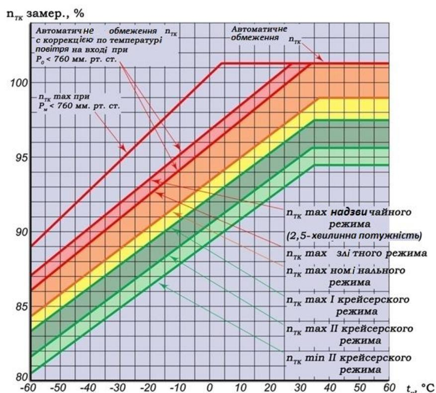
Рис. 6. Графік залежності частоти обертання ротора турбокомпресора від температури зовнішнього повітря на вході в двигун ( $H = 0, V = 0, P_h = 760$  мм. рт. ст.) і максимально допустимої частоти обертання ротора турбокомпресора при  $P_h < 760$  мм. рт. ст.
