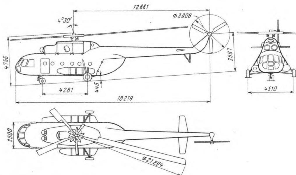
Рис. 1. Загальний вигляд вертольота
