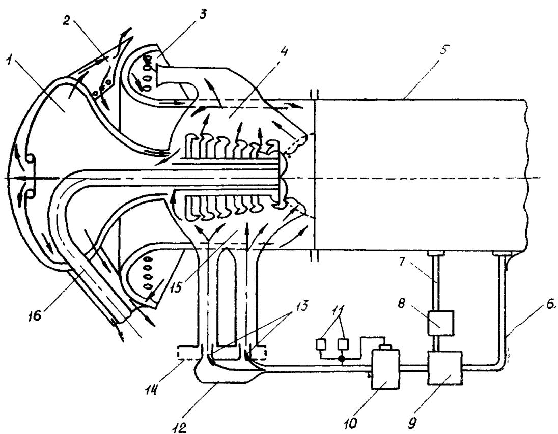
Рис. 3. Повітряно-теплова протильодова система пилозахисного пристрою вертольоту Mi-26:
