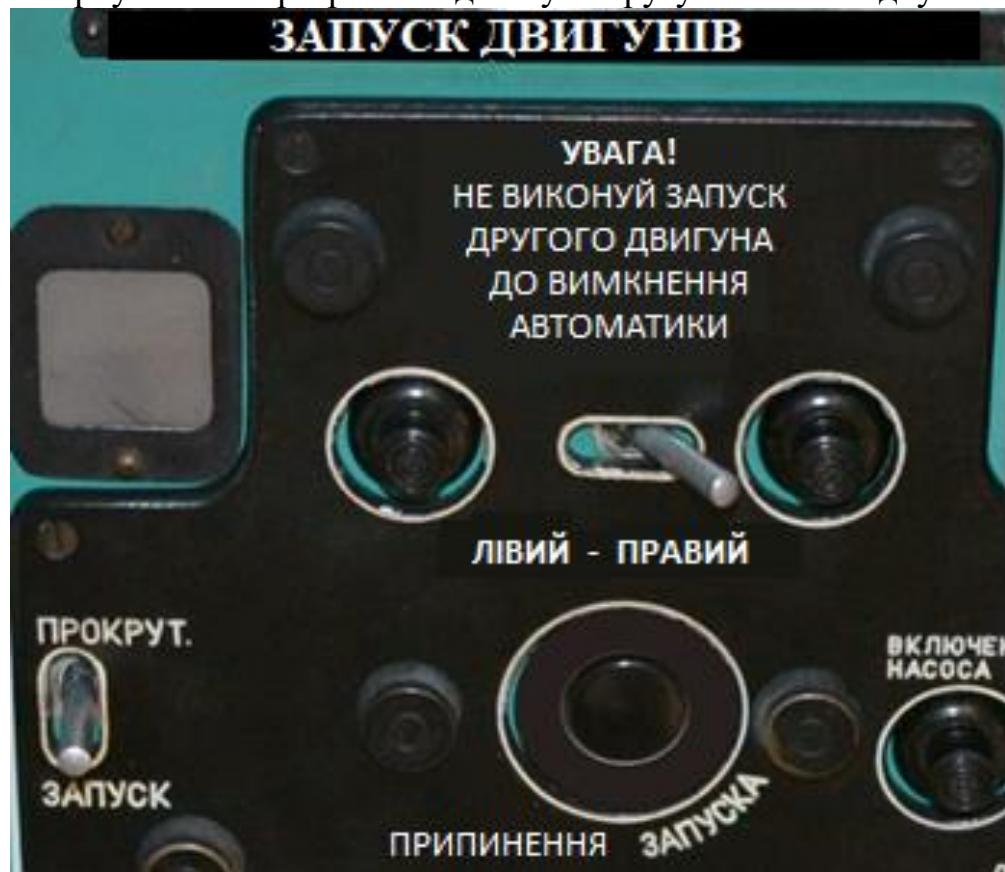
Рис.2 Щиток управління и контролю роботи системи запуска
