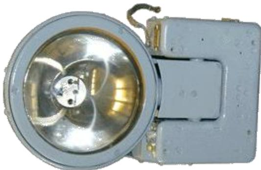
Включення світла фар і подача харчування до перемикачів випуску, прибирання і повороту фар здійснюється двома перемикачами «ФАРА СВІТЛО - приборати» при установці їх в положення «СВІТЛО». Перемикачі встановлені на лівому і правому бічних кронштейнах приладових дощок. Управління випуском, прибиранням і поворотом фар
