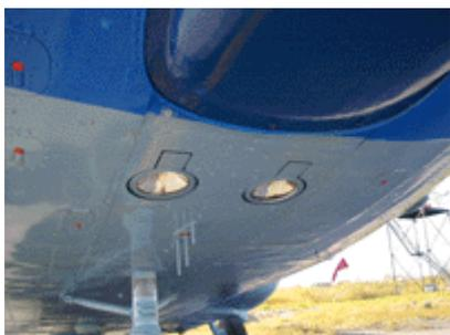
**Пошуково-посадочні фари ФПП-7М** з лампами ЛФСМ27-450-3 призначені для відшукування посадкового майданчика, освітлення місця посадки і місцевості при рулінні вертольота по землі, а також для освітлення місця вантажно-розвантажувальних робіт, вироблених з вертольота в нічний час і в погіршених метеорологічних умовах. Фара ФПП-7М,
