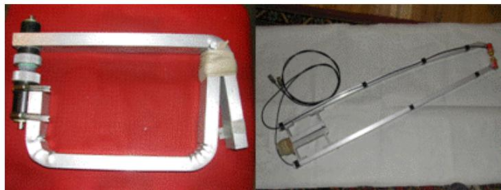
Рис. 2.6. Перетворювачі та безлюфтове оправлення для тіньового методу контролю
