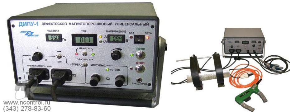
Рис. 2.3. Зовнішній вигляд і комплектність магнітного дефектоскопа
