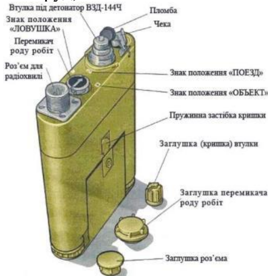
Малюнок. Міна МЗУ-2, загальний вигляд
