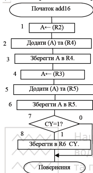
Рис. 1. Блок-схема алгоритму add16 додавання двохбайтових чисел
