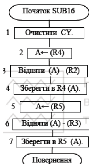
Рис. 3. Блок-схема алгоритму SUB16 віднімання двобайтових чисел
