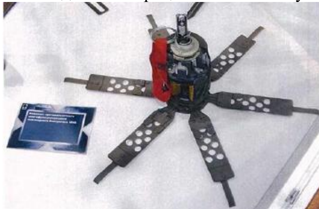
Малюнок. Міна-граната МИБ в бойовому положенні.
