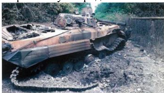
Малюнок .6.06.2015 р. Сокольники, БМП-2 після підриву на міні ТМ-57, 24 ОМБр, машина згоріла
