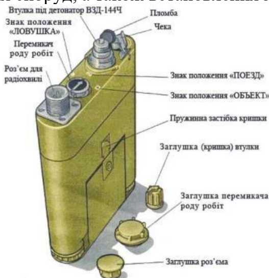
Малюнок. Міна МЗУ-2, загальний вигляд ТТХ міни МЗУ-2
