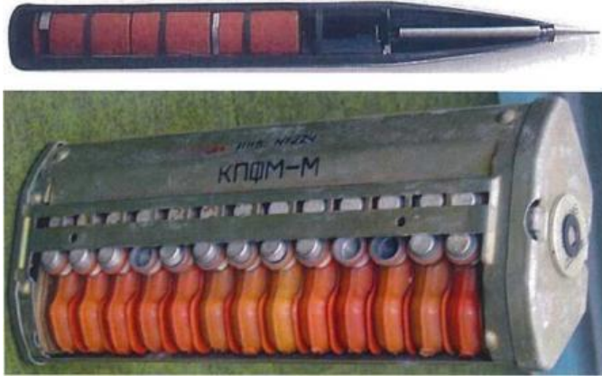
Головна частина ракети 9М27К3 і касета КПФМ-М на 26 мін
