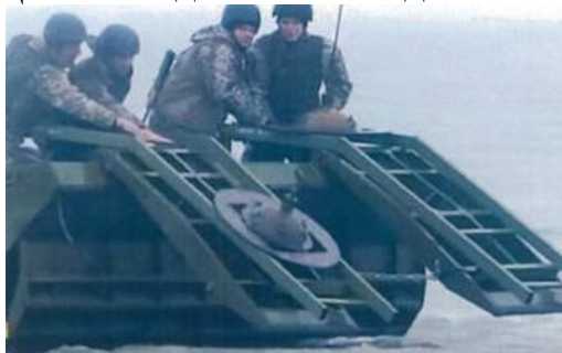
Встановлення мін ПДМ-1Мз ПТС
