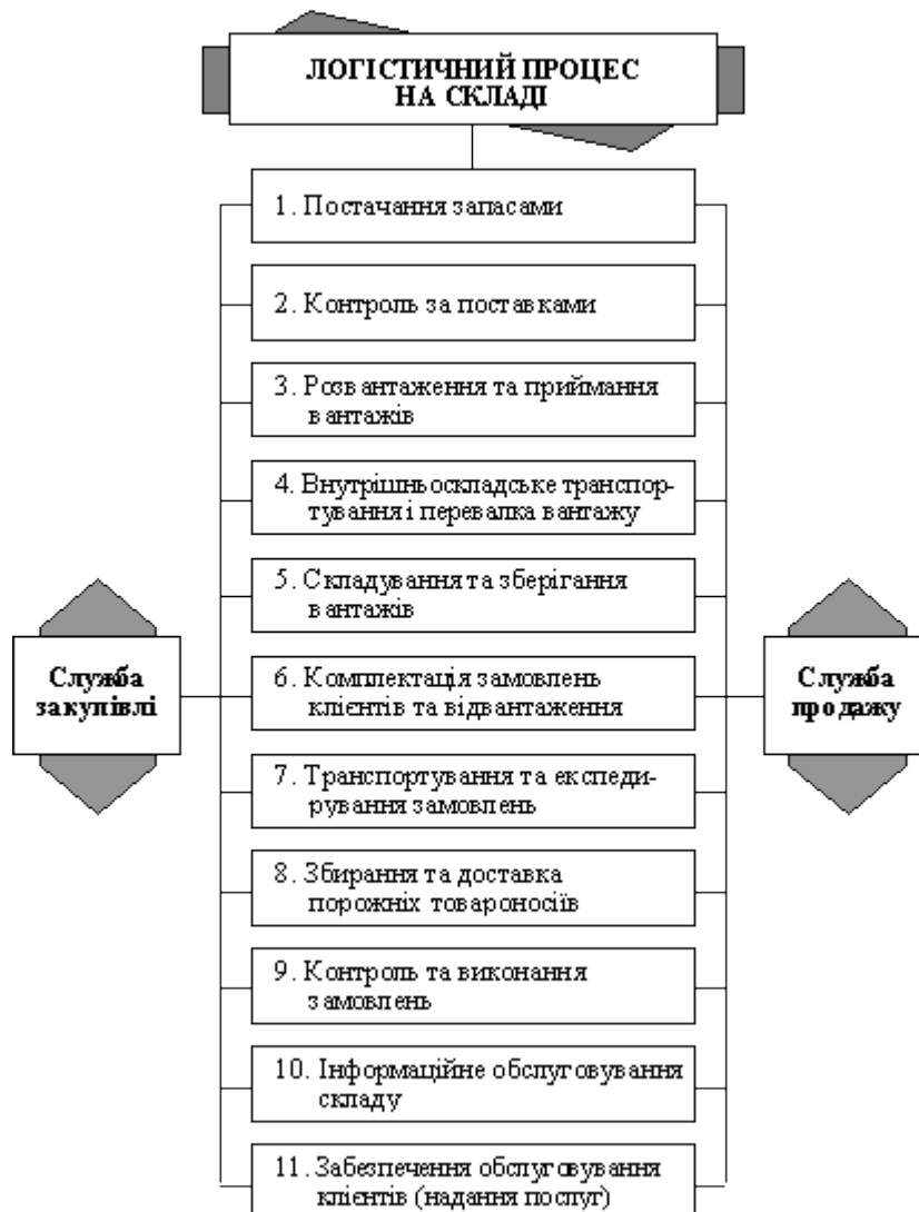
Рис. 10.1. Схема логістичного процесу на складі
