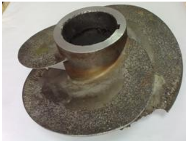
Рис. 2 – Кавітаційне зношення робочого колеса
