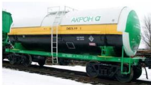
Рис. 7. - Залізнична цистерна з паровою сорочкою
