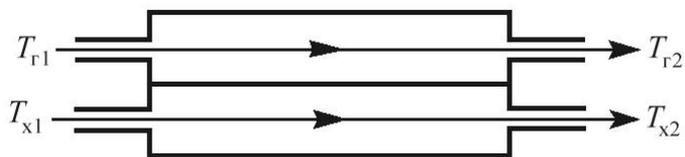
Схема проточного теплообмінника
