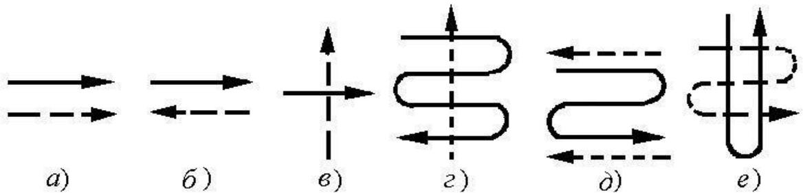
б) протиточні (б), коли теплоносії рухаються в протилежних напрямках;
