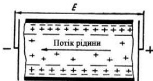
Рисунок 7 – Утворення подвійного електричного шару і рух рідини під впливом електричного поля
