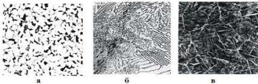
Рисунок 2 – Мікроструктури видів сталей: а – мікроструктура сталі із вмістом вуглецю 0,18 %, складається з фериту (світлі ділянки) і перліту (темні ділянки) ( < 300 ); б) при подальшому збільшенні ( < 800 ) чітко видно, що перліт має пластинчасту будову і включає дві структурні складові – тонкі пластинки цементиту і більш широкі феритні ділянки; в) мікроструктура сталі зі складом вуглецю більше 1 %, де перліт (темний) міститься у сітці з цементиту ( < 400 )
