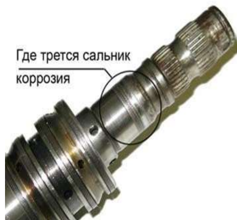
Рисунок 7 – Корозія при терті
