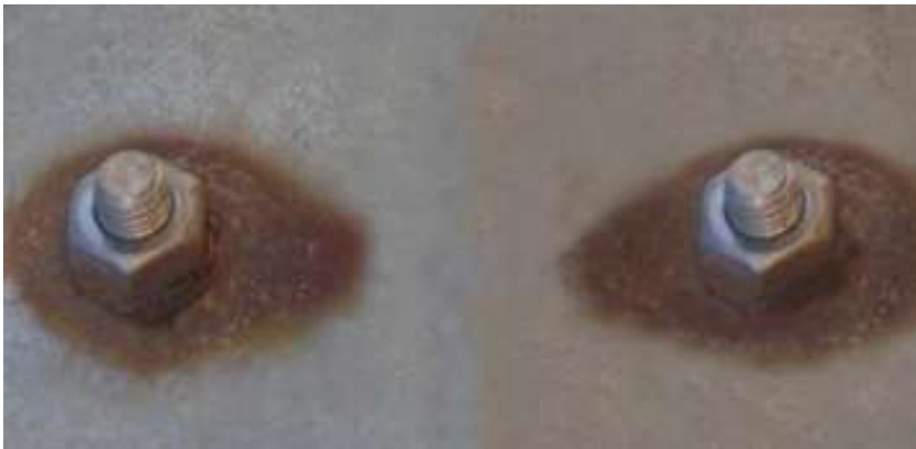
Рисунок 3 – Контактна корозія
