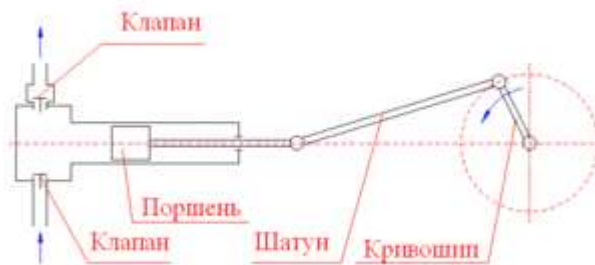
Рисунок 10.1 – Будова поршневого насоса одnobічної дії
