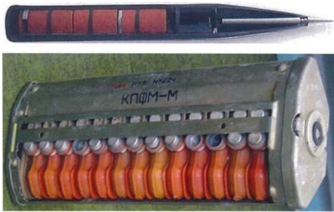
Головна частина ракети 9М27КЗ і касета КПФМ-М на 26 мін
