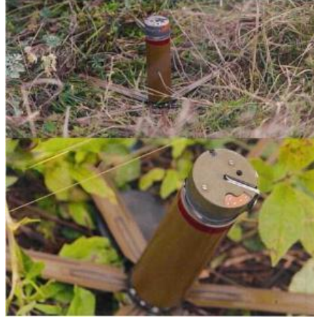
Міна ПОМ-3, встановлена на ґрунті
