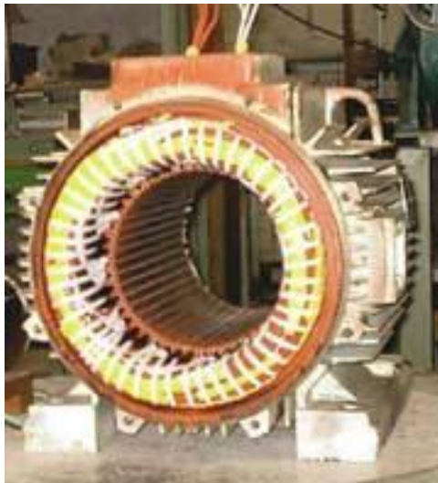
Рис. 1.2. Статор електродвигуна
