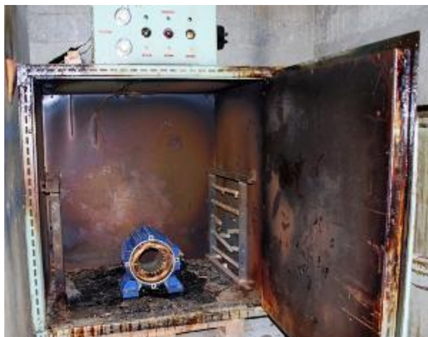
Рис. 1.6. Сушильна піч для сушіння ізоляції обмоток електричних двигунів
