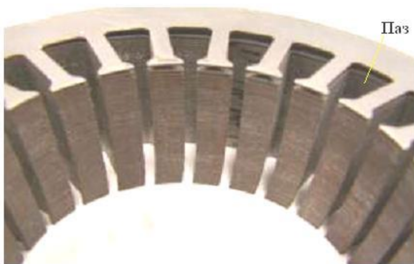
Рис. 5 Магнітопровід статора двигуна змінного струму
