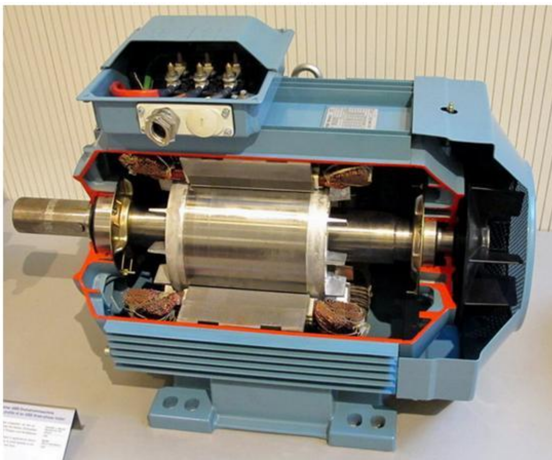
Рис. 11 Асинхронний двигун (розрізано)
