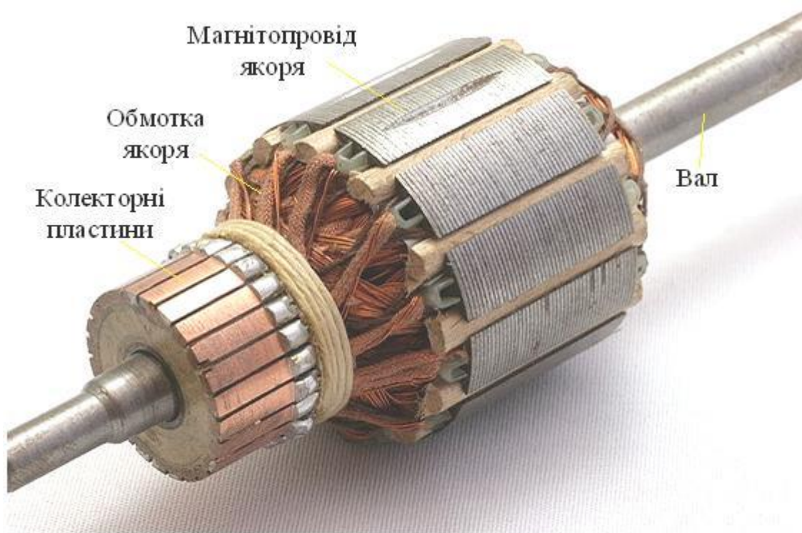
Рис. 14 Якір двигуна постійного струму
