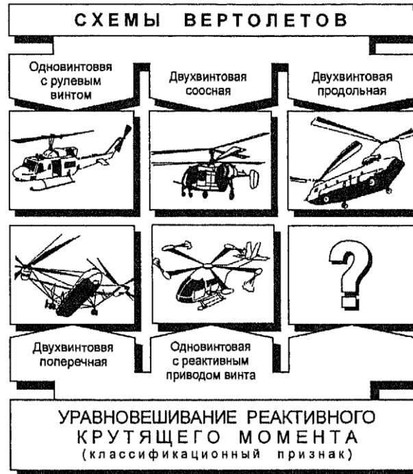
Рисунок 7 – Класифікація вертольотів за способом компенсації реактивного моменту несучого гвинта
