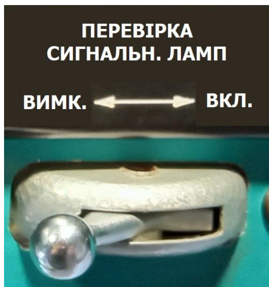
Рисунок - Перемикач перевірки справності ламп
