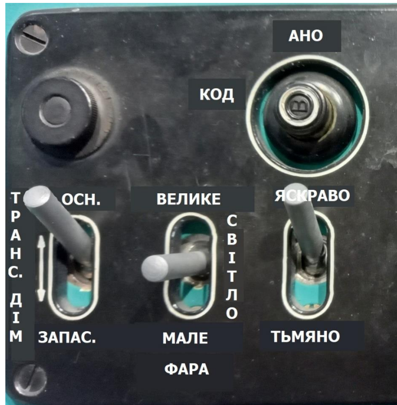
Рисунок - Щиток управління зовнішнім світлотехнічним обладнанням
