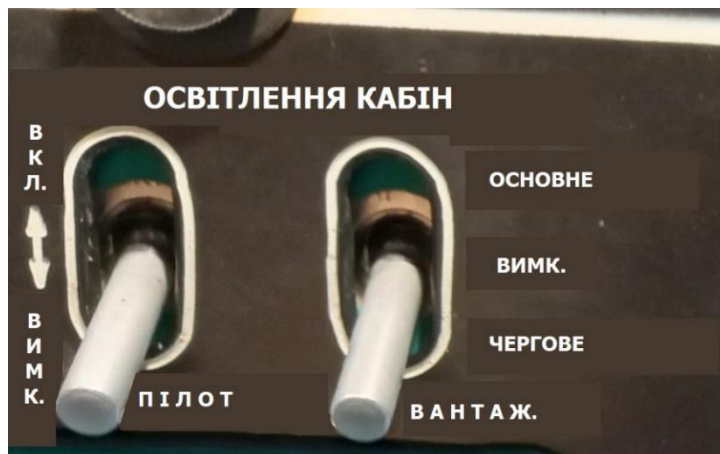
Рисунок - Щиток управління освітленням кабіни екіпажу
