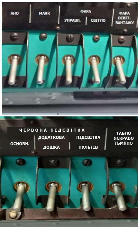
Рисунок - Щитки АЗСів світлотехнічного обладнання
