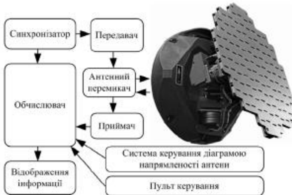
Рисунок 4 – Функціонування метеолокатора
