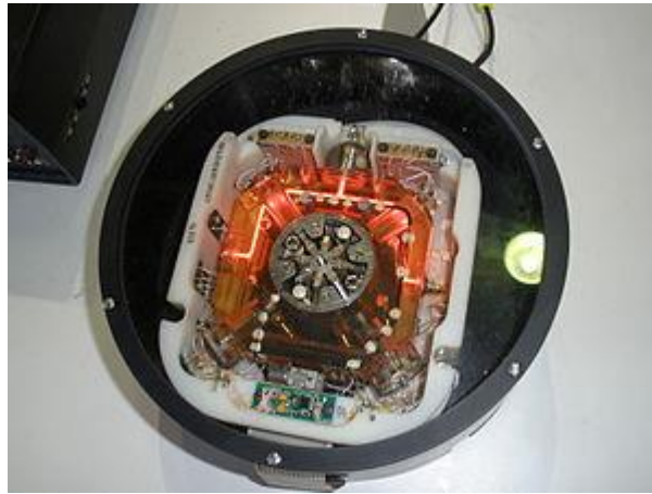
Рисунок 1 – Чутливий елемент сучасної ІНС
