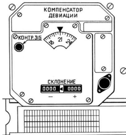
Рисунок 3 – Лицьова панель корекційного механізму КМ-2
