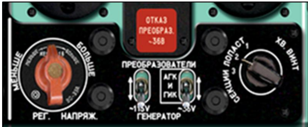
Рисунок 9 – Панель змінного струму верхнього електропульту
