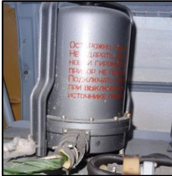
Рисунок 2 – Гіроагрегат Г-3М
