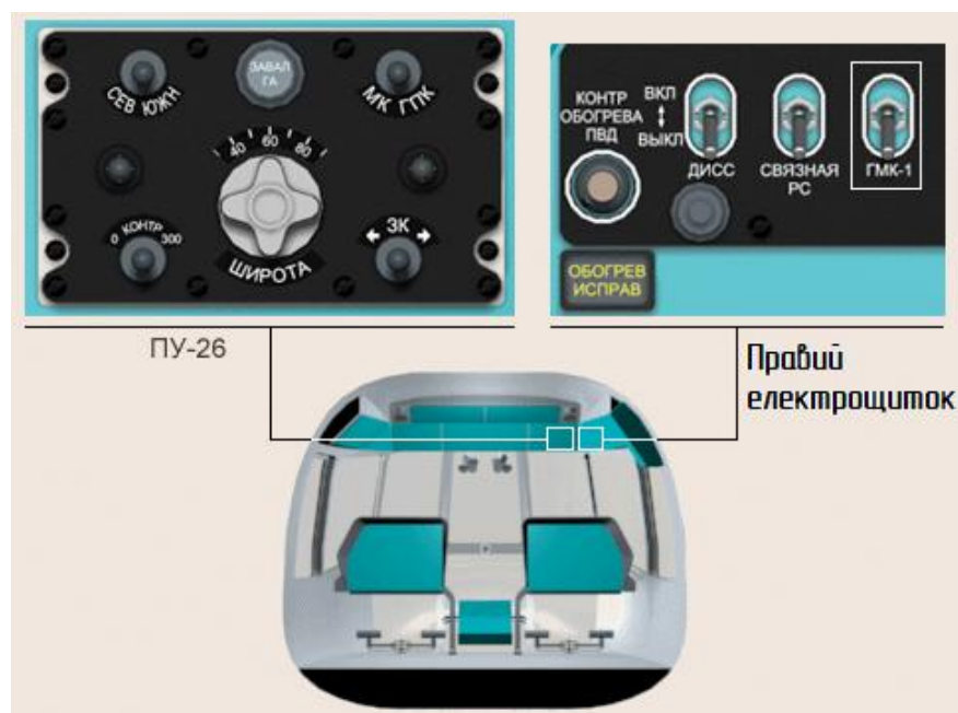
Рисунок 3 – Розміщення ПУ-26 та АЗСГК-5 «ГМК-1» на Мі-8МТВ
