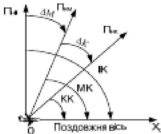
Рисунок 5 - Курсові кути літака: КК – компасний курс; МК – магнітний курс; ИК – істинний курс; Пн – північний істинний; Пнм – північний магнітний; Пнк – північний компасний
