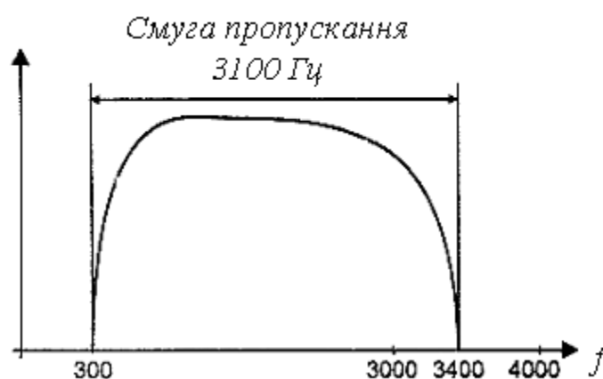
Рисунок 3 – Амплітудно-частотна характеристика каналу тональної частоти
