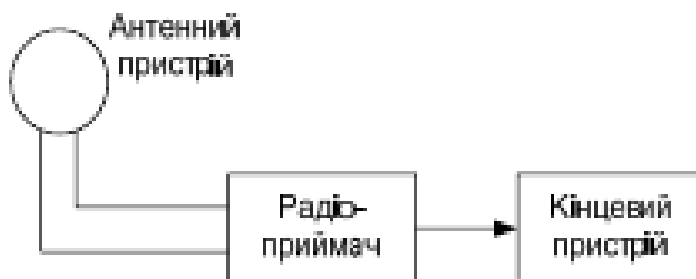
Рисунок 1- Функціональна схема радіопеленгатора
