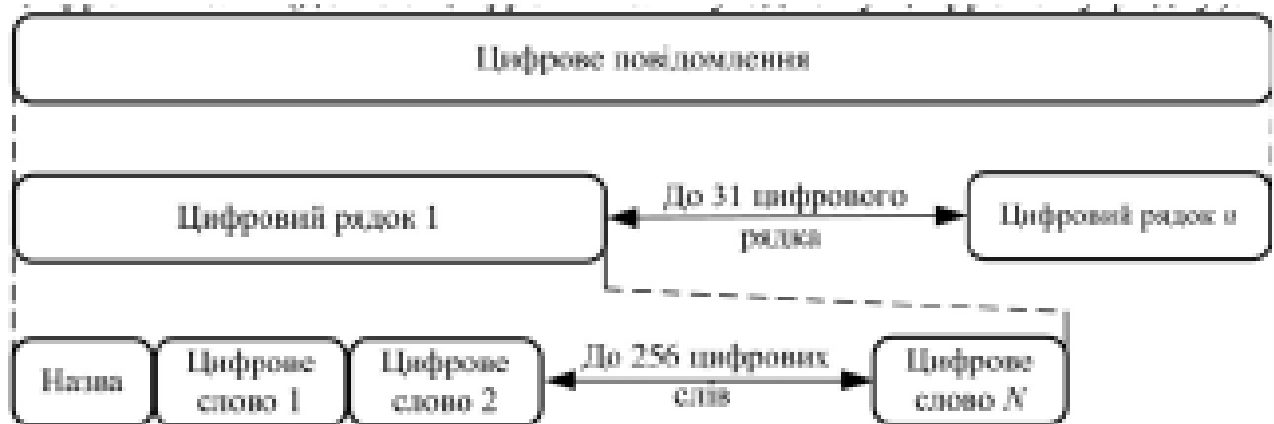
Рисунок 12 – Структура цифрового повідомлення ARINC 629
