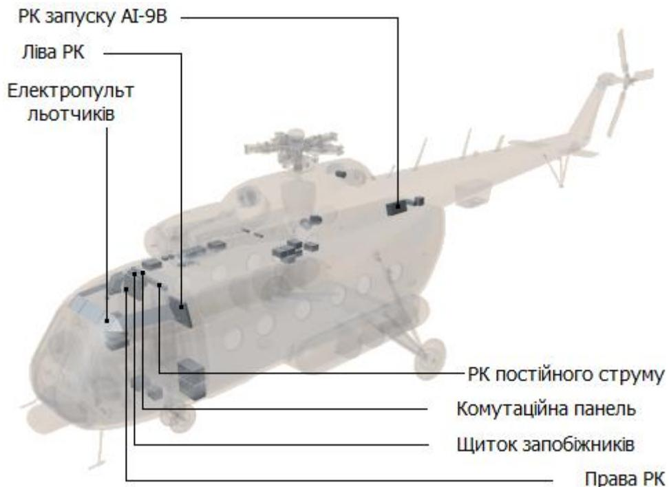
У розподільних пристроях розміщені комутаційна апаратура, прилади, табло, а також апаратура захисту і управління.
