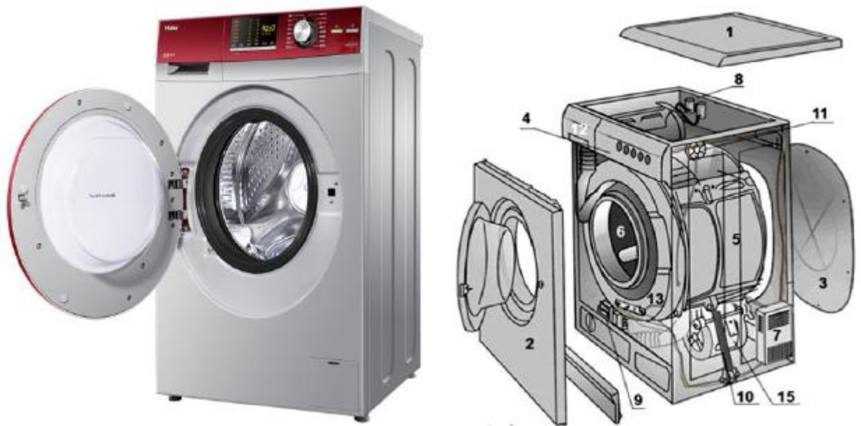
Рисунок 9 – Зовнішній вигляд автоматичної пральної машини та її основні елементи: 1 – кришка; 2 – передня панель; 3 – задня панель; 4 – панель керування; 5 – бак; 6 – барабан; 7 – електронний модуль; 8 – впускний клапан; 9 – сливний насос; 10 – амортизатор; 11 – пресостат; 12 – емність для порошків; 13 – тен; 14 – ремень; 15 – електричний двигун
