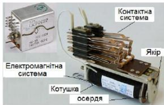
Рисунок 9 – Конструкція і основні елементи електромеханічного контактного реле
