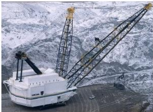
Рисунок 4 – Загальний вигляд і схема спеціалізованої землерийної машини: 1 – ківш; 2 – тяговий канат; 3 – підйомний канат; 4 – платформа; 5 – механізм повороту
