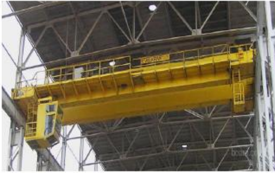
1 – міст; 2 – шляхи; 3 – механізм пересування; 4 – візок; 5 – гак
