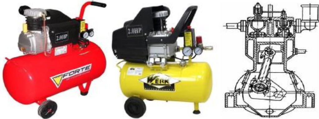
Рисунок 8.11 – Зовнішній вигляд і схема поршневого компресора
