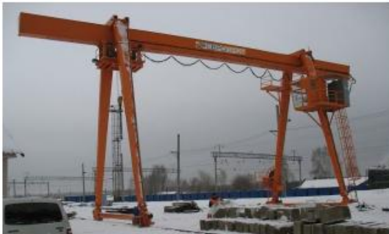
1 – несуча ферма; 2 – опори; 3 – візки; 4 – механізм пересування; 5 – грейфер
