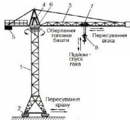
1 – вежа; 2 – візки крану; 3 – стріла; 4 – головка вежі; 5 – консоль противаги; 6 – поворотний круг; 7 – візок; 8 – гак
