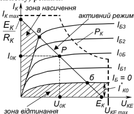
Рисунок 8 – Вихідна динамічна характеристика транзистора
