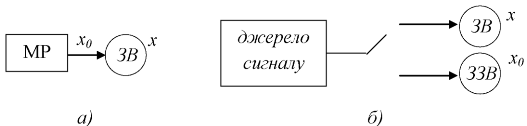
Рисунок 1 – Схема повірки ЗВ: а) зі зразковим сигналом (мірою), б) зі зразковим засобом вимірювання (ЗЗВ).
